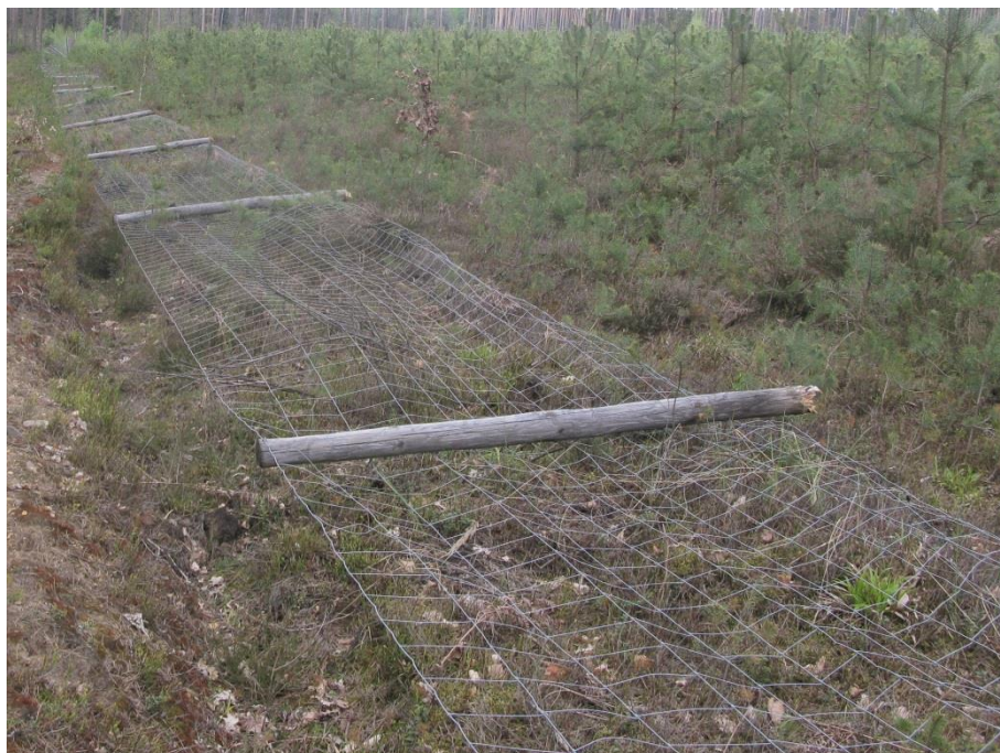
Fot. 3. Uszkodzone ogrodzenie na powierzchni testującej – słupki drewniane wytrzymały 6 lat (Fot. J. Kowalczyk)
